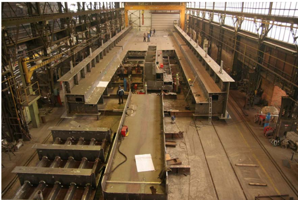
Obr. 3 Dílenská sestava mostovky a trámu
