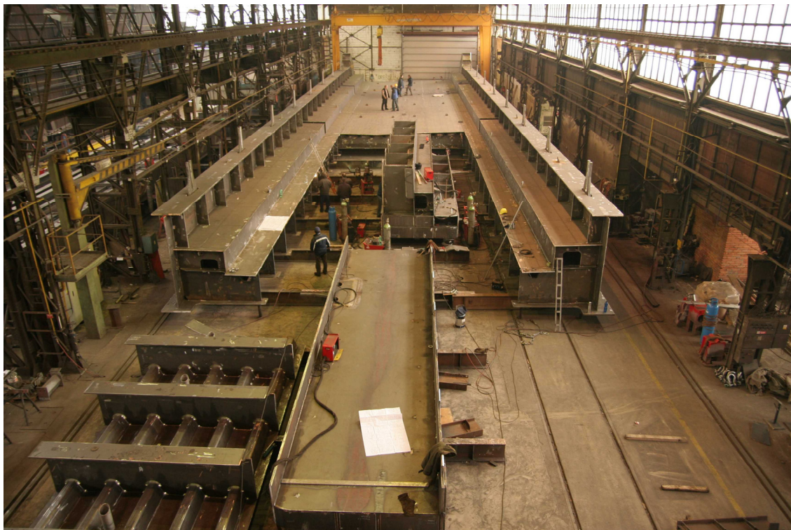
Obr. 3 Dílenská sestava mostovky a trámu
