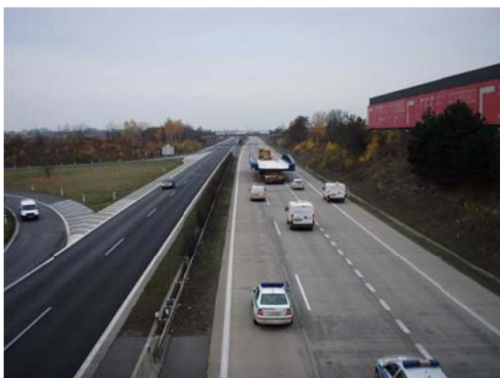
Obr. 11 Přeprava NK mostu (dálnice D11)
