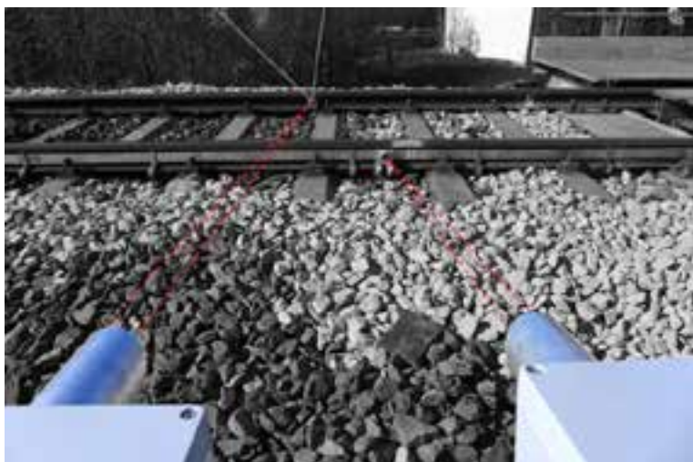
Obr. 3 Princip měření nainstalovaným systémem ObjectSense
