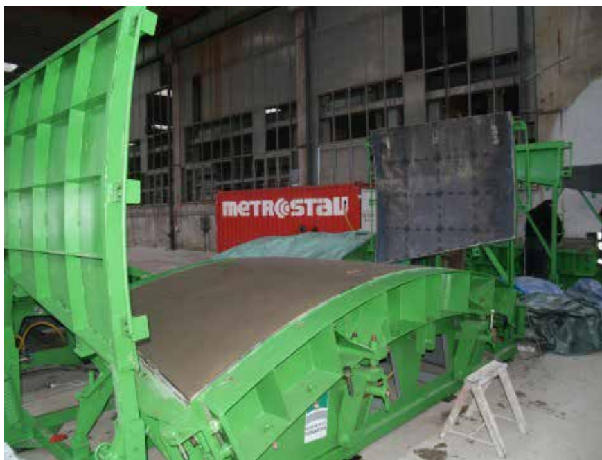
Obrázek 12: Zkušební dílec segmentového ostění pro tunel Ejpovice
