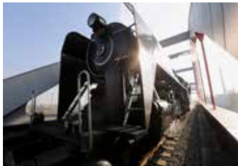
Obr. č. 9: Zatěžovací zkouška-parní lokomotiva
