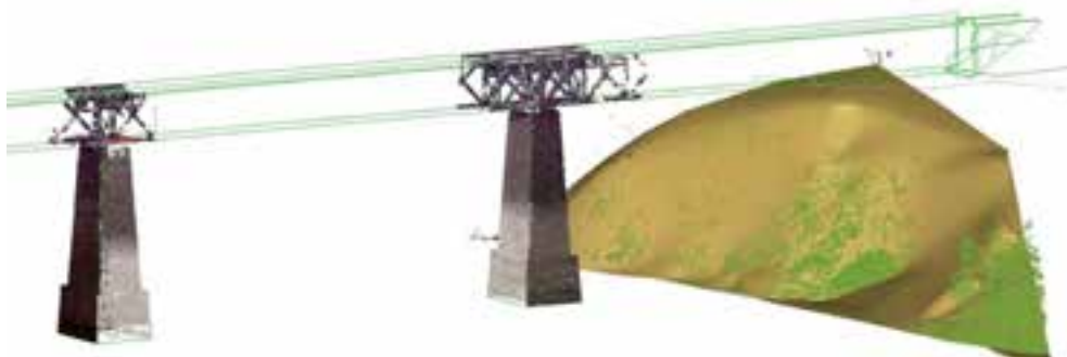
Obr. 3 Výsledné zobrazení 3D - scanu mostní konstrukce
