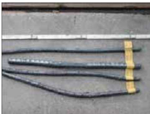
Obrázek 4: Pruty výztuže zdeformované působením vysoké teploty
