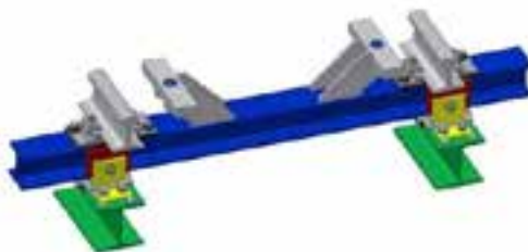
Obr. 2 – Celkový pohled na konstrukci s ocelovou mostnicí
