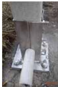
Obr. 6 Deformace a síla při zatížení zábradlí na opěře – madlo a sloupek, průhyb při zkoušce a porušení při dosažení únosnosti v patce
