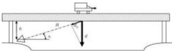
Obr. 2: Skutečná a měřená deformace
