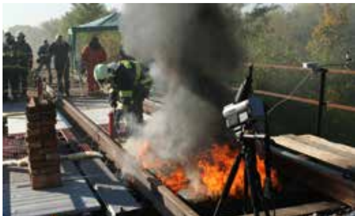
Obr. 7 Poloha mechanického zatížení, termokamery a anemometru během požárních zkoušek
