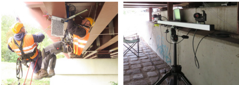
Obr. 7 – Osazení odrazných desek (CDT SŽ) a měřící sestava ve Vranovicích
