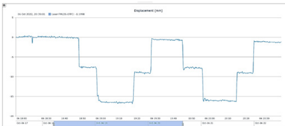
Obr. 2 – Záznam průhybu ze statické zatěžovací zkoušky
