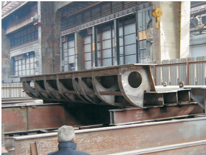
Část OK před nátěrem
