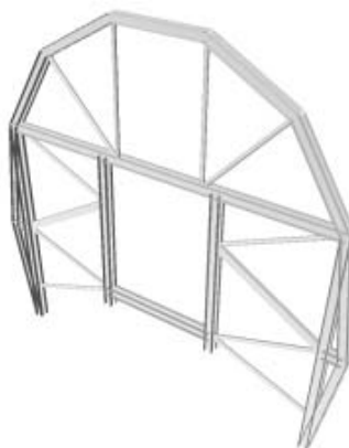
Prostorové schéma nosného prvku (rámu) bednění
